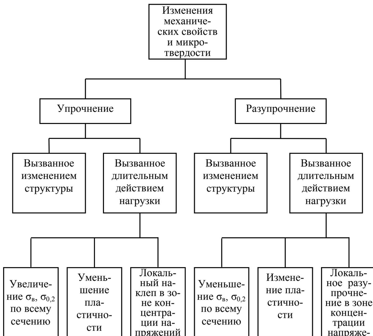
Рис. 8. Изменение механических свойств (схема)
