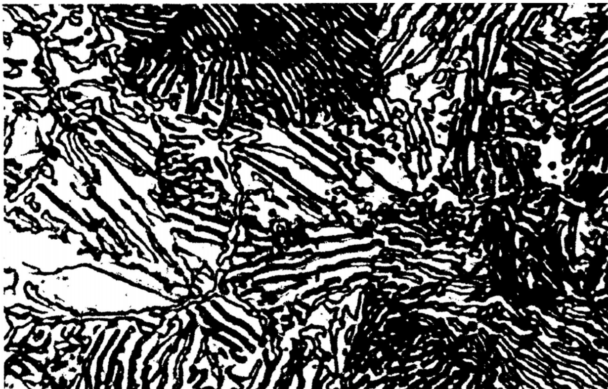
Рис.2. Пластинчатый перлит в заэвтектоидной стали
