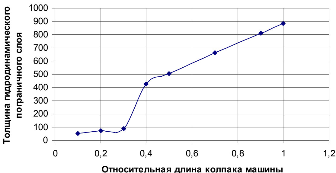
Рис. 6.26. Изменение толщины гидродинамического пограничного слоя по длине колпака машины
