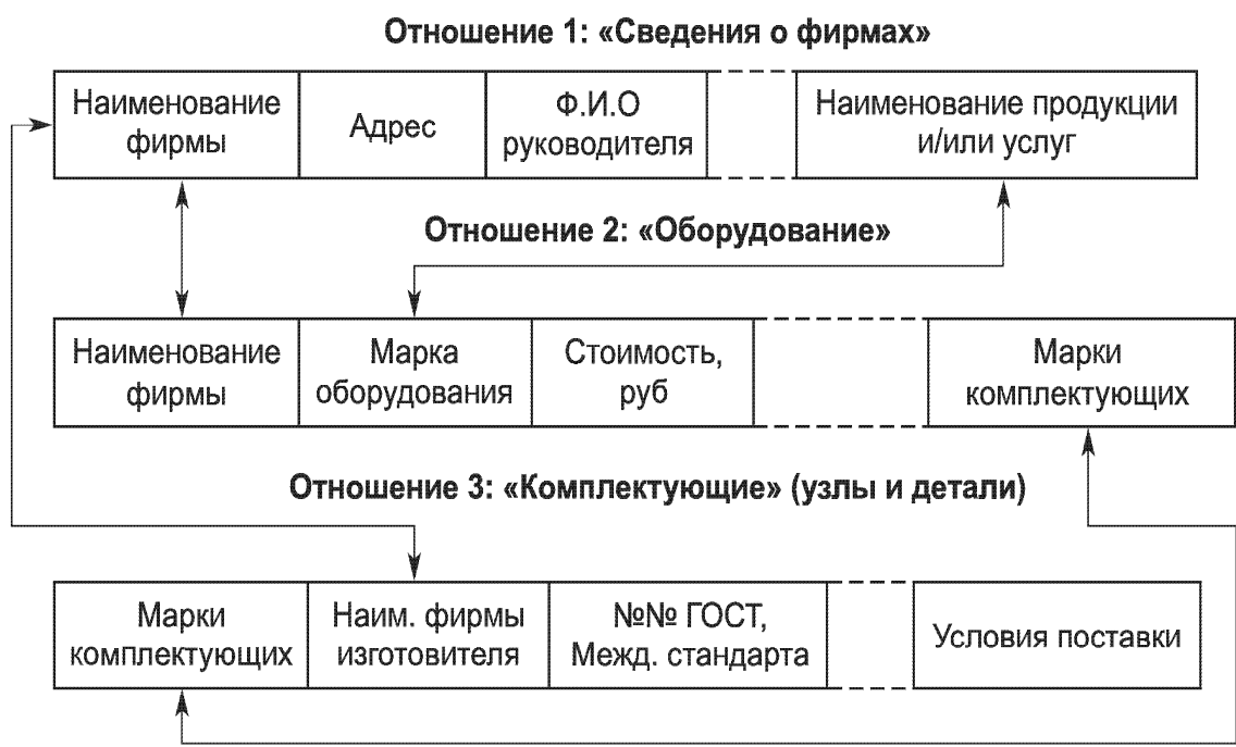
Рис. 5. Принцип организации связей между разными отношениями в реляционной модели с использованием двух доменов: первый определяет область возможных значений атрибутов "Наименование фирмы" в отношении 1 и "Фирма изготовитель" в отношениях 2 и 3; второй определяет область возможных значений атрибутов "Наименование продукции и/или услуг" в отношении 1, "Марка оборудования" в отношении 2 и "Марка комплектующих" в отношении 3
