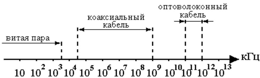
Рис. 3.2. Полосы пропускания различных кабелей
