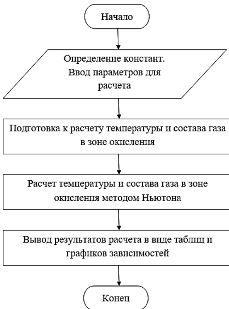
Рис. 2. Алгоритм моделирования зоны окисления
