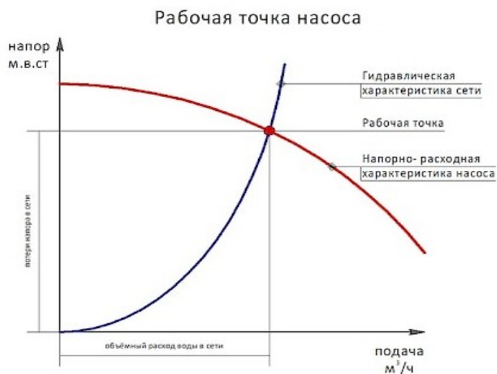
Рис. 2. График характеристик сети и насосного агрегата
