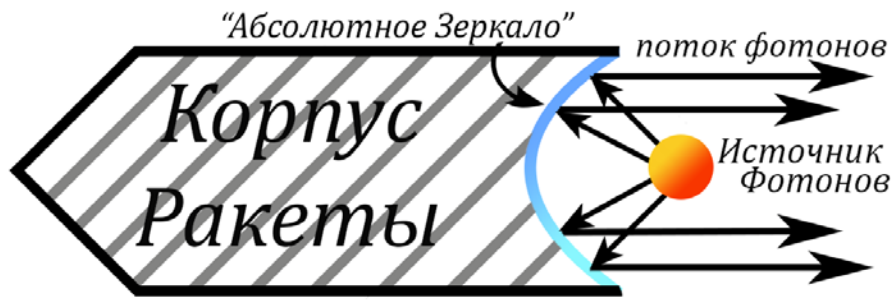
Рис. 2. Схема фотонного двигателя
