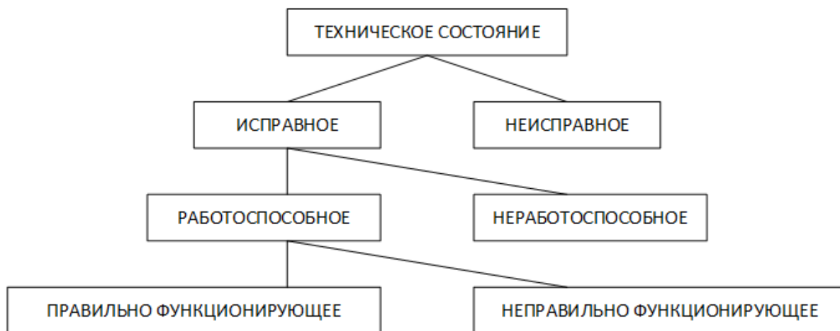
Рис. 1.2. Виды технических состояний
