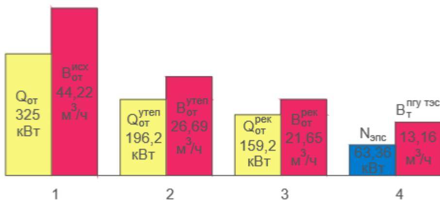
Рис.3.7. Сравнительная диаграмма расхода потребляемого топлива и потребляемой энергии для различных вариантов отопления жилого дома (без нагрузки ГВС)
