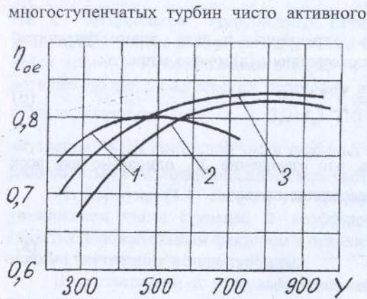
Рис.4.2. Зависимость относительного эффективного КПД турбины от характеристического коэффициента
