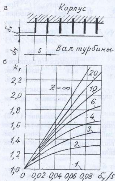
Рис. 3.11. Схема прямоточного уплотнения (а) и кривые для определения поправочного коэффициента K_y (б)
