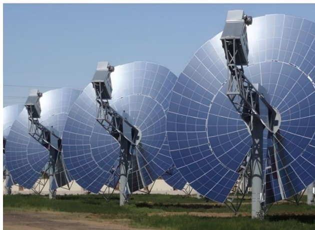
Рисунок 2.10 – Следящая система концентраторов СТЭУ
