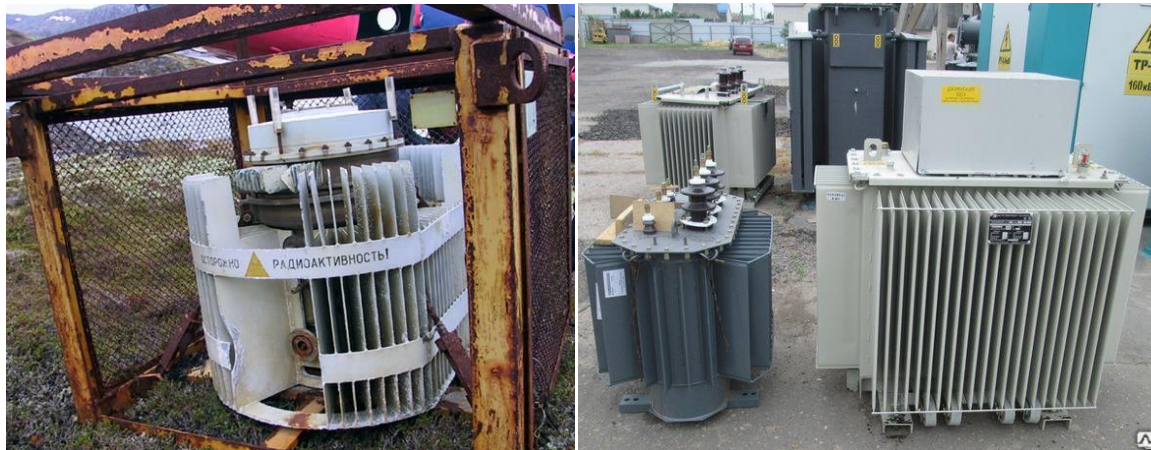
Рисунок 1.30 – Внешний вид РИТЭГ перед установкой
