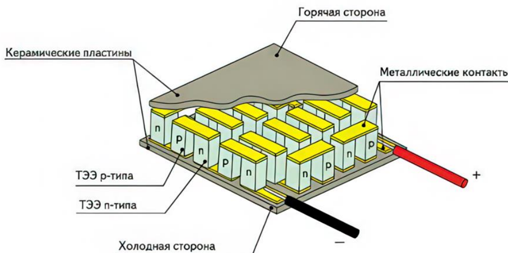
Рисунок 1.6 – Термоэлектрический генераторный модуль в разрезе
