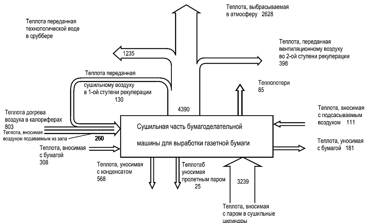
Рисунок 3.5 – Тепловой баланс сушильной части БДМ
