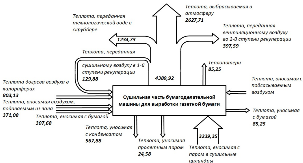
Рисунок 1.8 – Тепловой баланс БДМ
