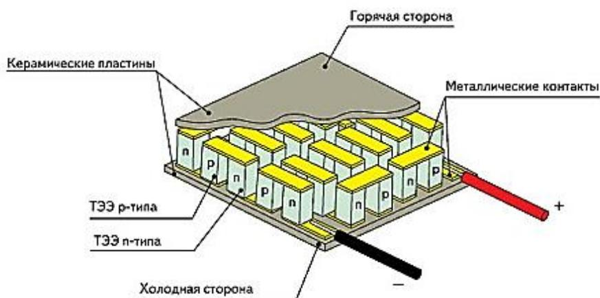
Рисунок 5 – Термоэлектрический генераторный модуль в разрезе
