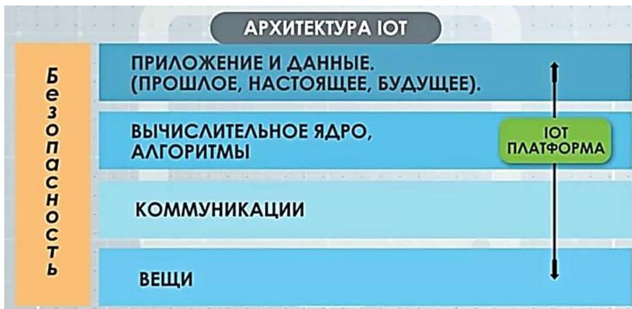
Рисунок 1 – Архитектура IoT
