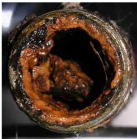
Рисунок 1 – Обрастание трубопровода железобактериями
