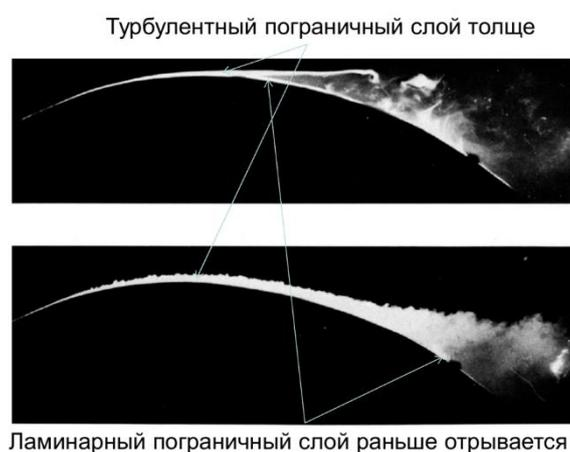
Рисунок 5.9 – Эксперимент. Пограничный слой
