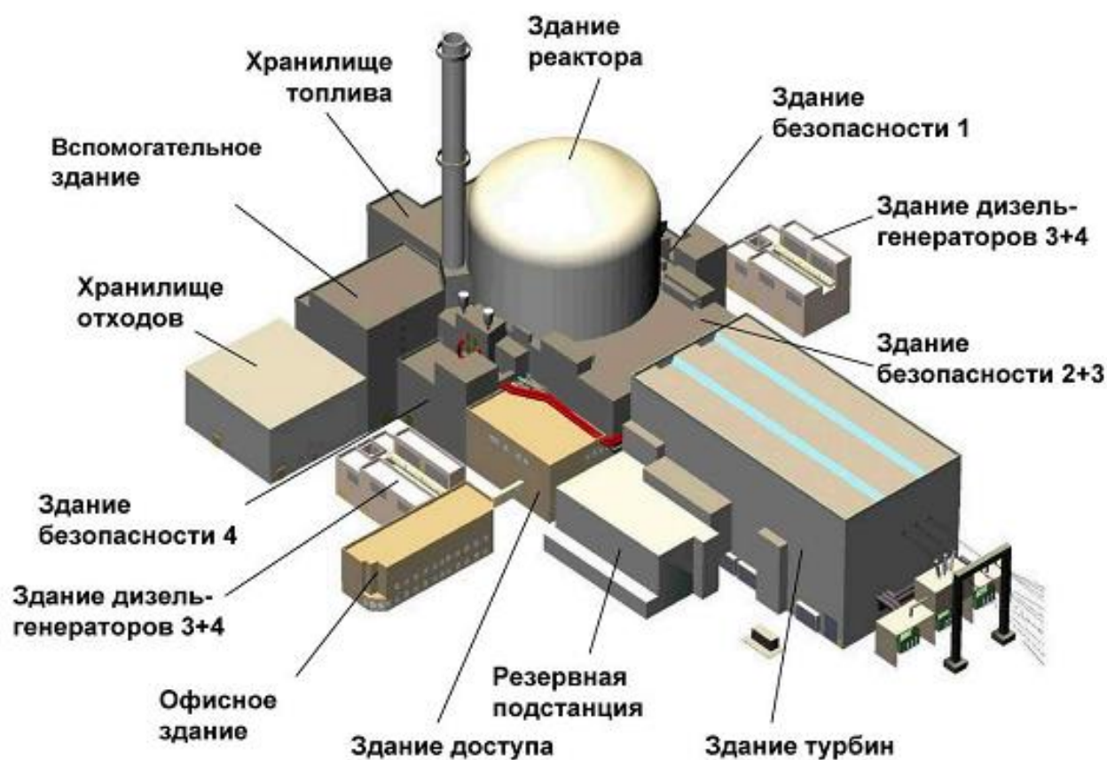
Рисунок 3.1 – План электростанции Areva Nuclear Power
