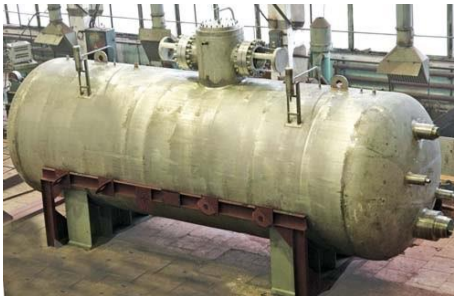
Рисунок 5.5 – Фото деаэратора АЭС на заводе-изготовителе
