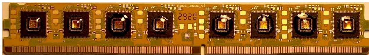
Рисунок 6. Модуль нейроморфного акселератора с 8 прототипами НП «Алтай»
