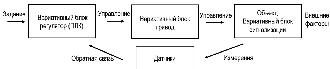
Рисунок 4. Модульный концепт обучающего стенда
