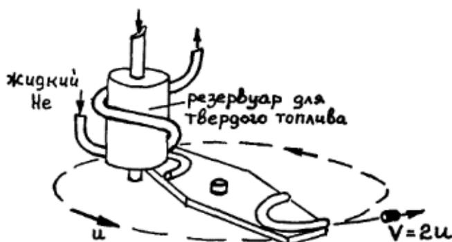
Рисунок 2.7 – Центробежный инжектор для инъекции таблеток
