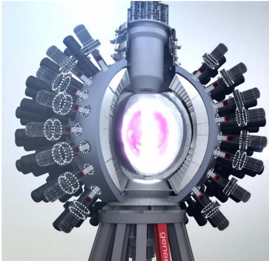
Рисунок 1.33 – Взрывная камера создаваемой в России установки ИТС «ИСКРА-6». Со всех сторон в камеру будет вводиться 128 лучей, генерируемых фиолетовым лазером на стекле с неодимом. Импульс длительностью 3 нс будет нести энергию 300 кДж, длина волны лазера – 350 нм. На сегодня уже построены и используются в экспериментах четыре лазерных канала (установка «Луч») с энергией в импульсе 12 кДж
