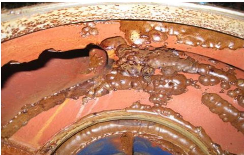
Рисунок 2.19 – Повреждения, наносимые эффектом кавитации (часть насоса)
