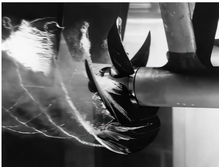
Рисунок 2.17 – Кавитационный след гребного винта
