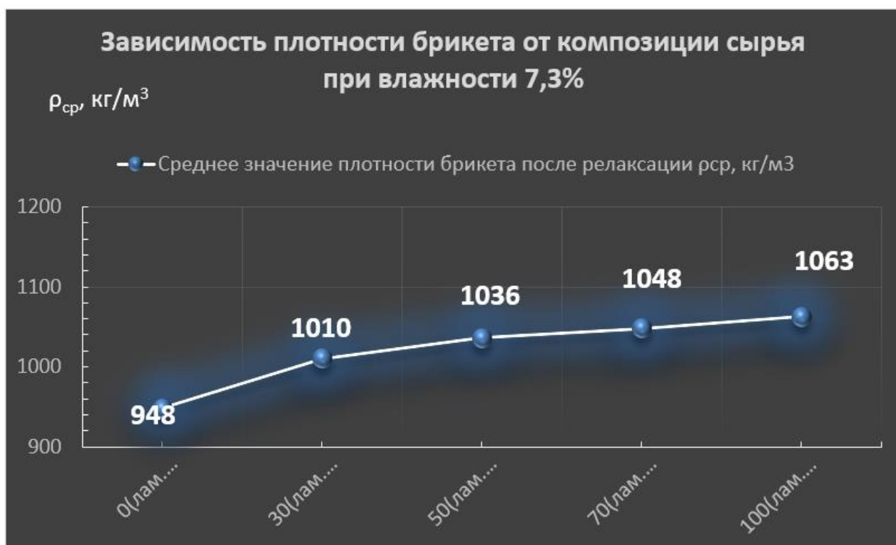
Рисунок 3 – График зависимости плотности брикета от композиции сырья при влажности 7,3 %
