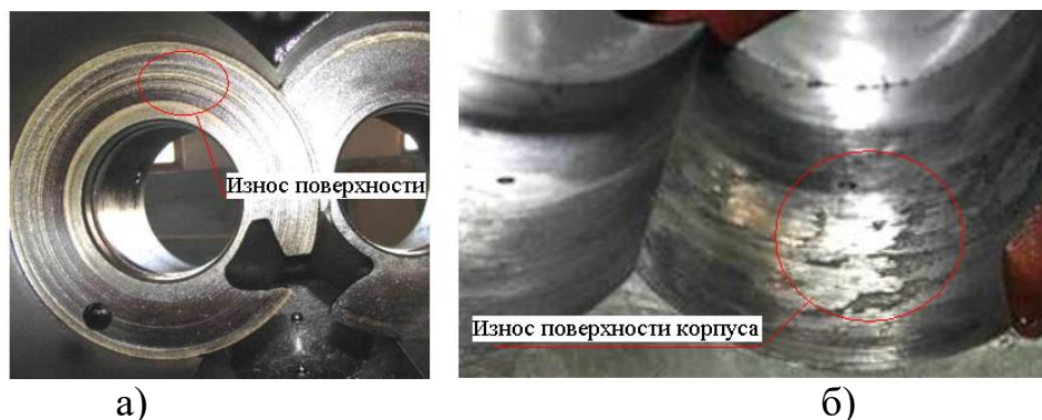
Рисунок 4 – Повреждения корпуса: а) износ поверхности задней крышки; б) износ цилиндрической поверхности корпуса
