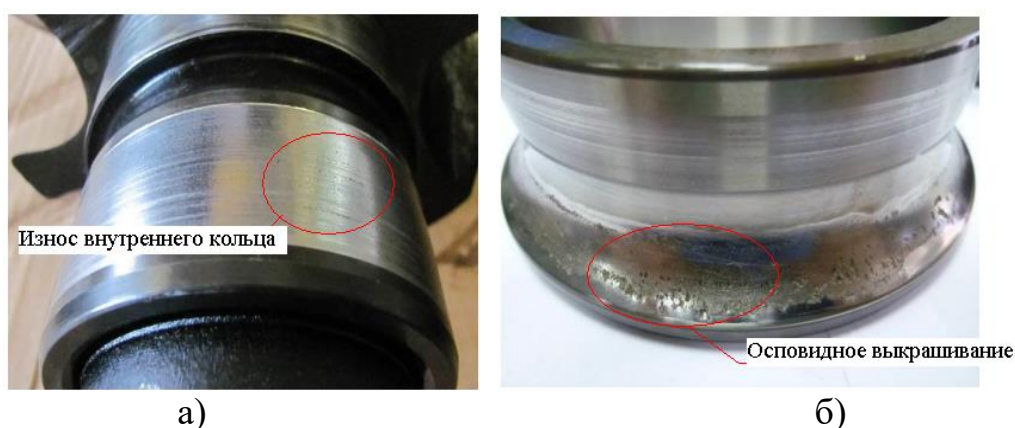
Рисунок 3 – Повреждения подшипников качения: а) износ внутреннего кольца; б) осповидное выкрашивание беговой дорожки внутреннего кольца
