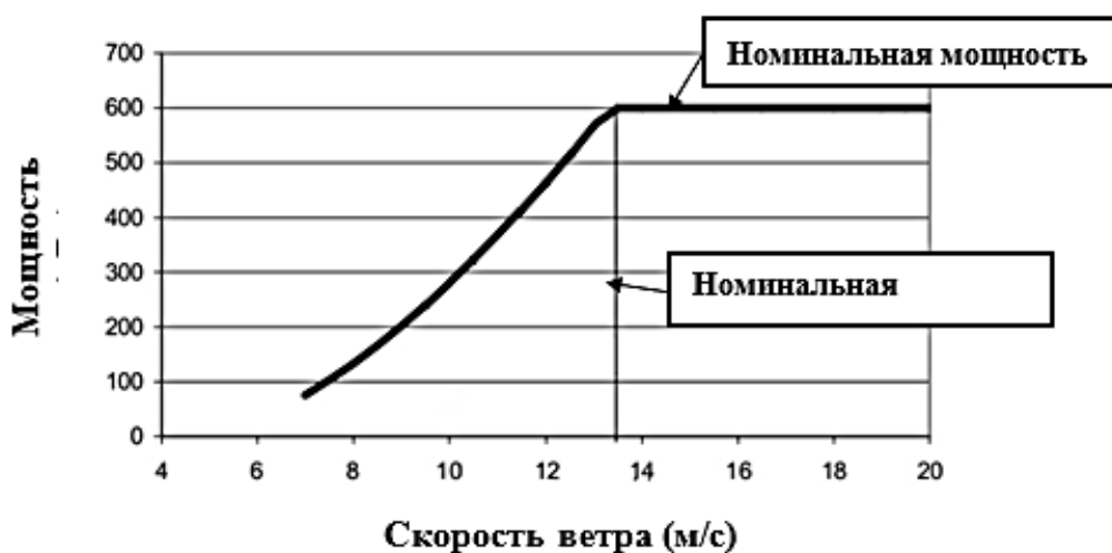
Рисунок 2. Зависимость мощности от скорости ветра
