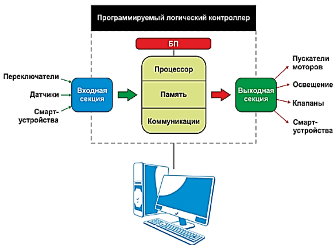
Рисунок 1. Состав и принцип действия ПЛК
