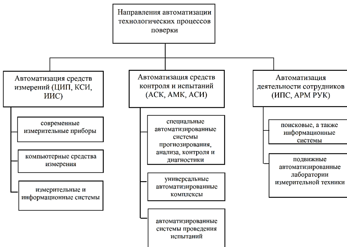
Рисунок 2. Основные направления автоматизации технологических процессов поверки
