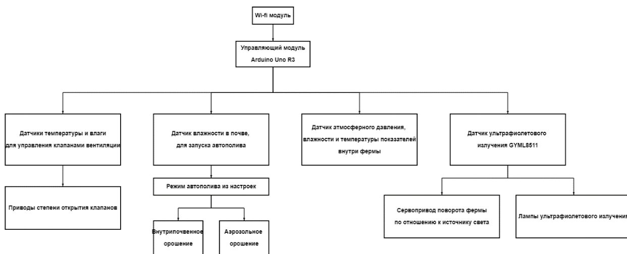
Рисунок 2. Блок-схема модулей автоматизированной фермы
