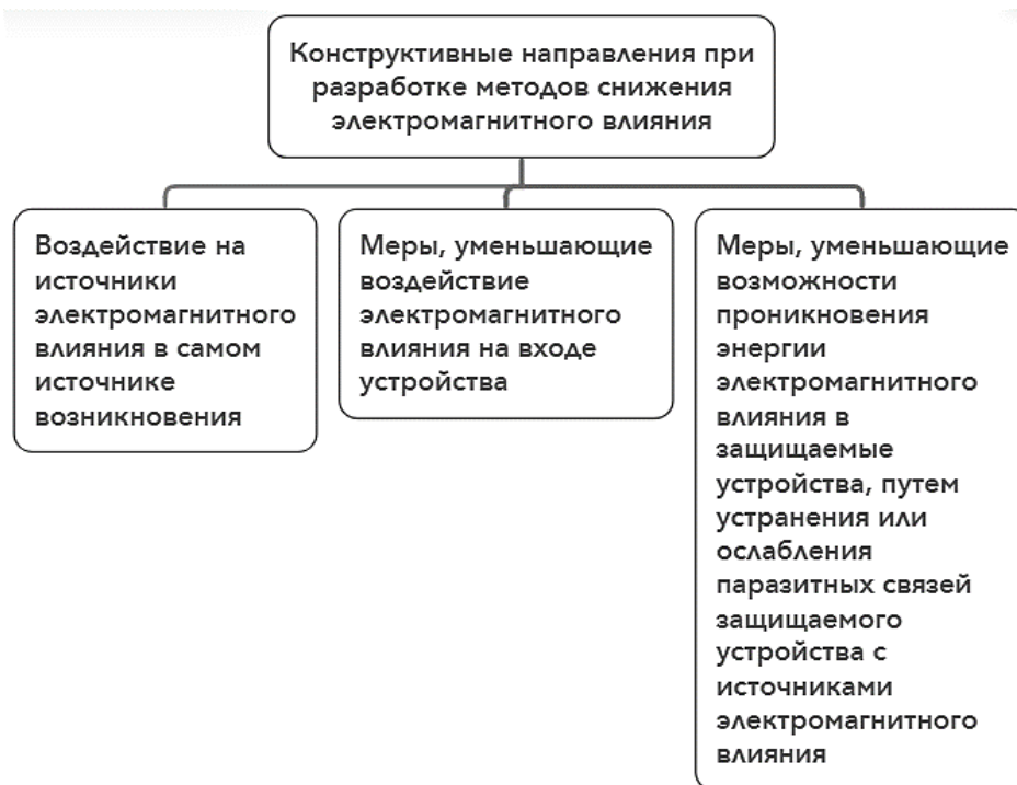
Рисунок 2. Основные конструктивные направления при разработке методов снижения электромагнитного влияния
