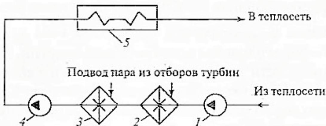
Рис. 4.4. Принципиальная схема теплоподготовительной установки ТЭЦ:
