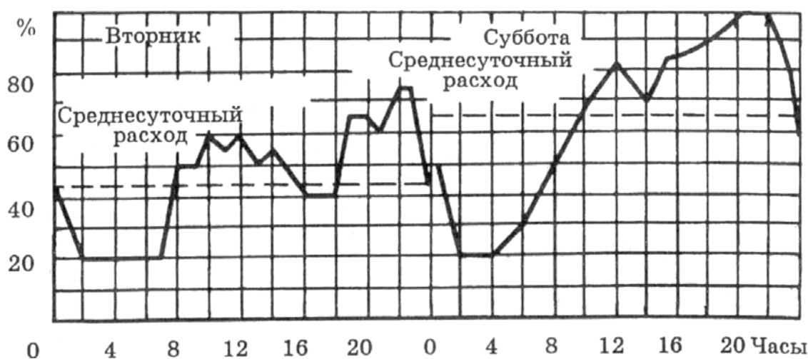
Рис. 1.2. Суточный график горячего водоснабжения жилого района
