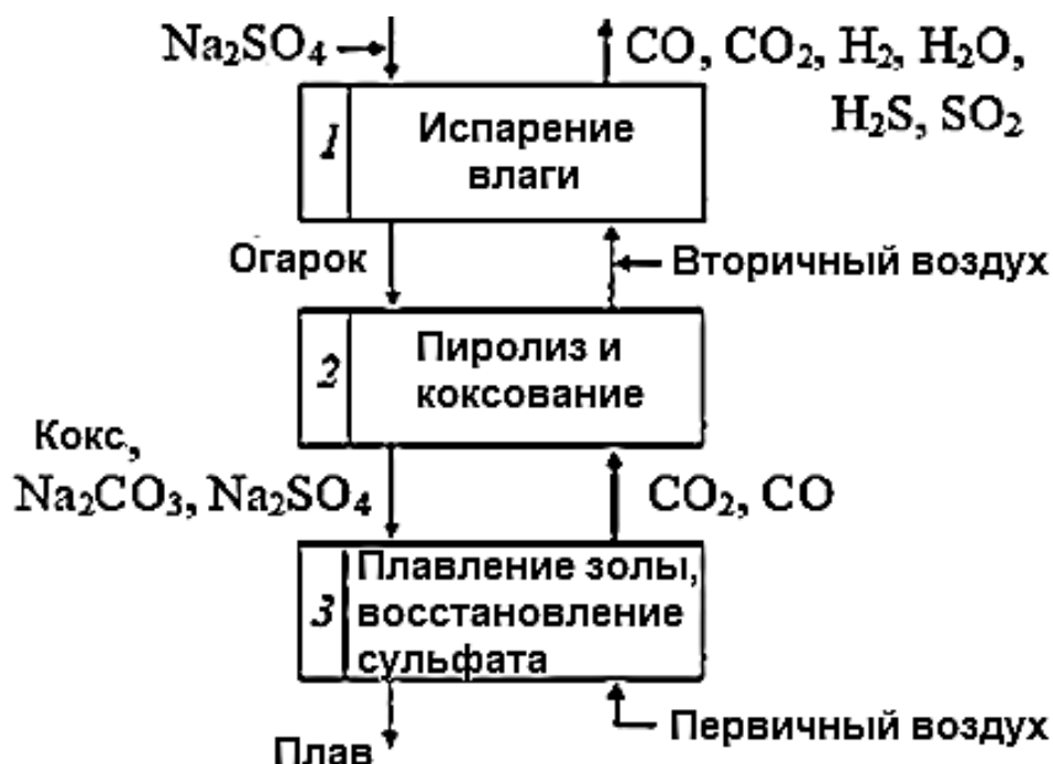
Рис. 2.2. Процесс сжигания черного щелока
