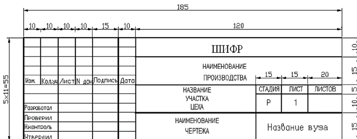
Рис. 2. Основная надпись для чертежей и схем ГОСТ 2.104-68 «Единая система конструкторской документации. Основные надписи» [6]
