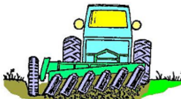
Плуг на роликовом ходу. Вместо скользящих пластин плуг имеет ролики. Таким плугом можно пахать вдвое быстрее.
