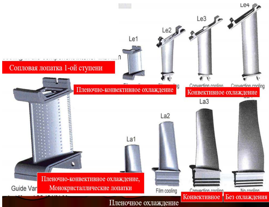
Рис. 3.9. Система охлаждения лопаток 4-х ступенчатого ГТД V94.3А
