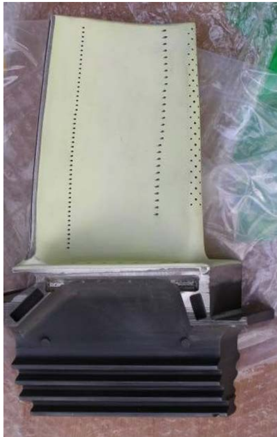
Рис. 3.6. Выход охлаждаемого воздуха из РЛ
