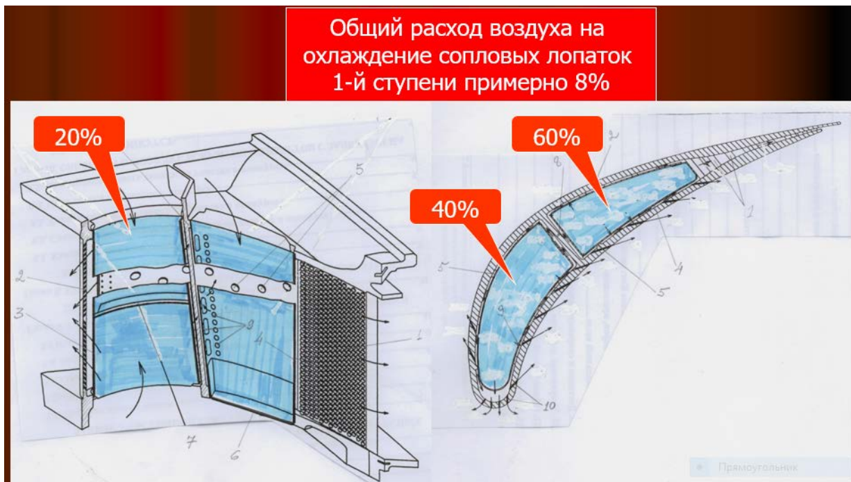
Рис. 3.8. Устройство сопловой лопатки, и распределение воздуха на охлаждение ее частей
