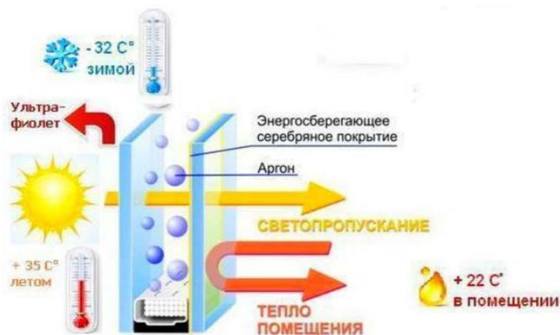
Рис. 32. Энергосберегающая камера триплекса окна с И-стеклом
