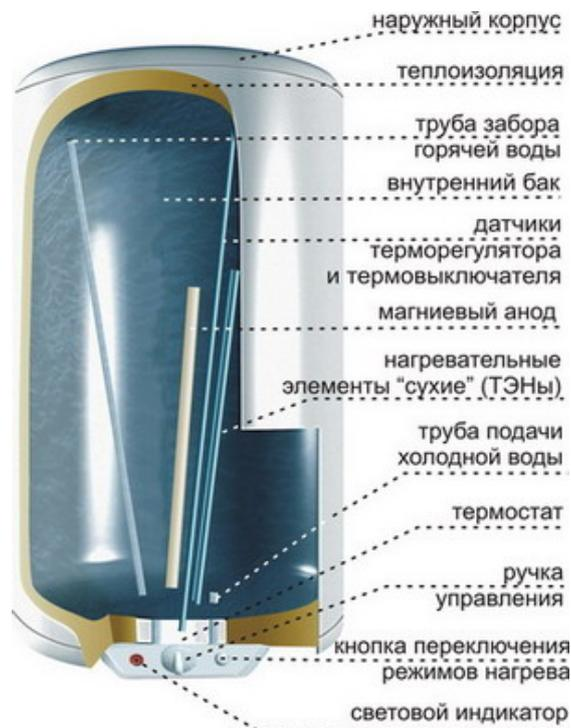
Рис. 54. Схема устройства емкостного водонагревателя
