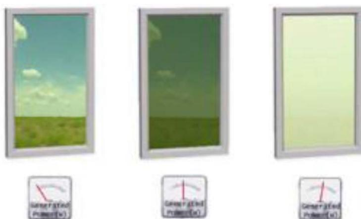
Рис. 38. Возможные варианты светопропускания стекла с электрообогревом
