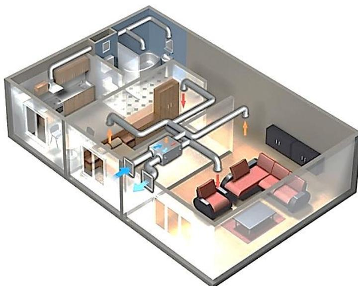
Рис. 43. Схема приточно-вытяжной системы вентиляции отдельной квартиры на базе вентиляционной установки с рекуператором
