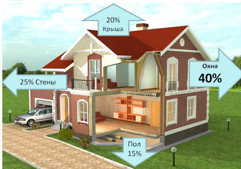
Рис. 29. Основные тепловые потери через ограждающие конструкции
