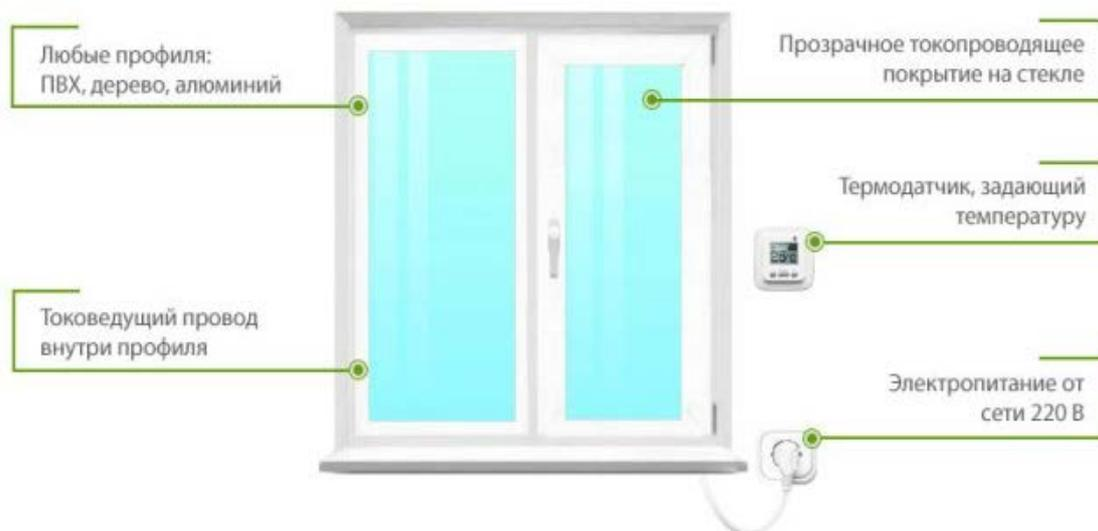
Рис. 37. Компоненка системы низкоэмиссионного окна с электрообогревом стекол
