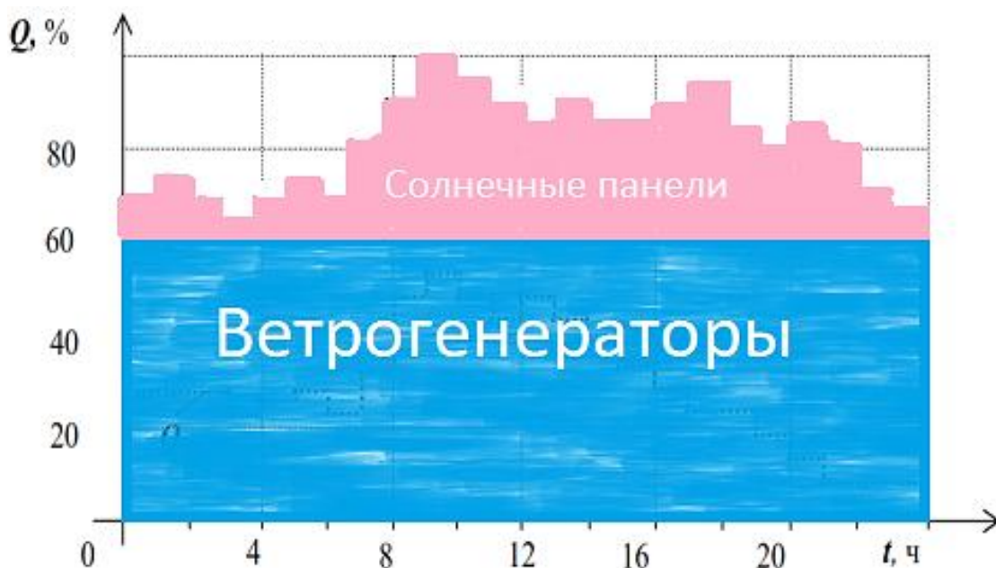
Рис. 5 – Вариант покрытия суточного графика нагрузки в нормальном режиме
