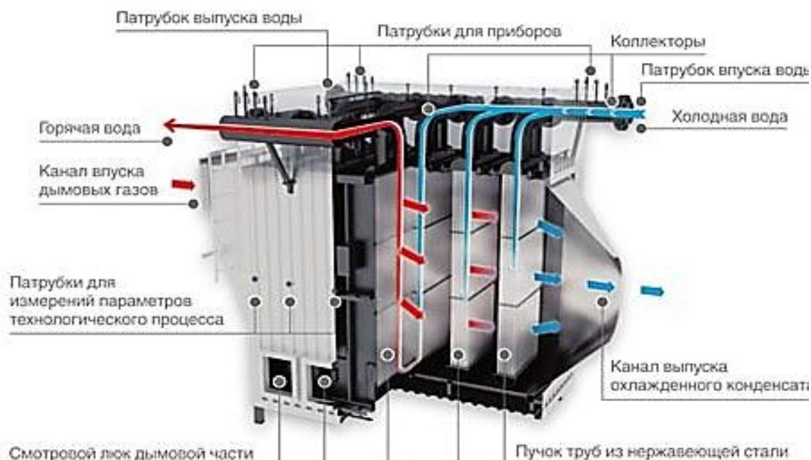
Рис. 1 - Принципиальная схема конденсационного экономайзера
