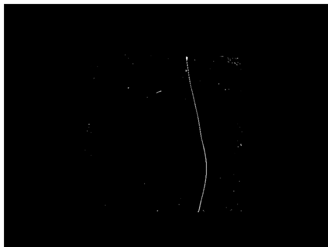
Рис.4. - Обработанное изображение плитки с дефектом в виде неглубокой трещины
