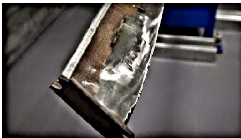
Рис. 2 - Поврежденные лопатки турбины К-1200-240
