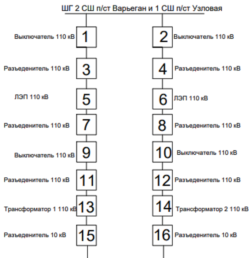
Рис.4 - Блок схема для расчета надежности подстанции
