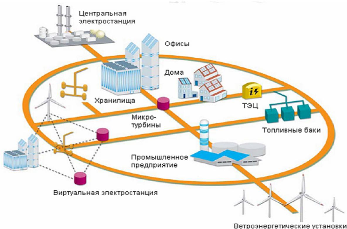
Рис. 3.29. Схема smart grid — «энергетического интернета»
