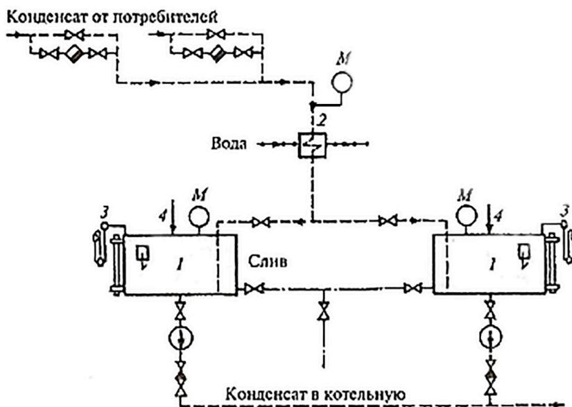
Рис 2.6. Система сбора конденсата закрытого типа: 1 – конденсатный бак; 2 – охладитель конденсата; 3 – выкидное предохранительное приспособление; 4 – подача пара для поддержания избыточного давления; М – манометр
