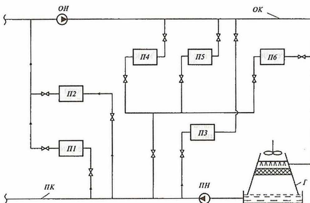
Рис. 2.11. Централизованная система обратного водоснабжения: П1-П6 – потребители охлажденной воды; Г – вентиляторная градирня; ПК – подающий коллектор; ОК – коллектор обратной воды; ПН, ОН – насосы подающей и обратной линий
