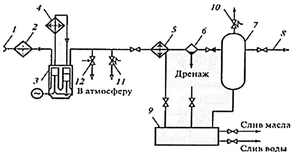
Рис. 2.17. Принципиальная схема компрессорной установки с поршневым двухступенчатым компрессором
