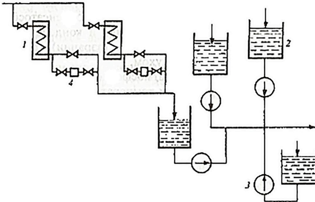
Рис. 2.5. Система сбора конденсата открытого типа с перекачивающими насосами: обозначения те же, что на рис. 2.3
