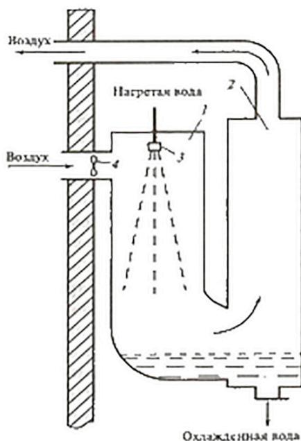
Рис. 2.12. Водоохладитель эжекционного типа с выносным сепаратором: 1 — зона контакта; 2 — зона сепарации; 3 — форсунка; 4 — закручивающие лопасти
