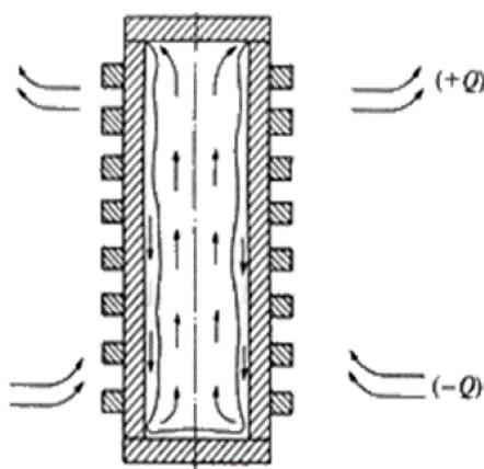
Рис. 3.2. Тепловой элемент теплообменника на термосифонах
