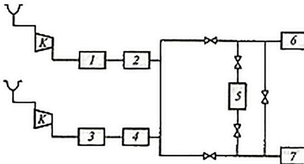
Рис. 2.13. Схема воздуhosнабжения промышленного предприятия: К – воздушный турбокомпрессор; 1-7 – потребители сжатого воздуха
