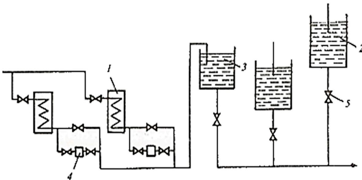
Рис. 2.4. Система сбора конденсата открытого типа (самотечная высоконапорная схема): 5 – обратный клапан; остальные обозначения те же, что на рис. 2.3
