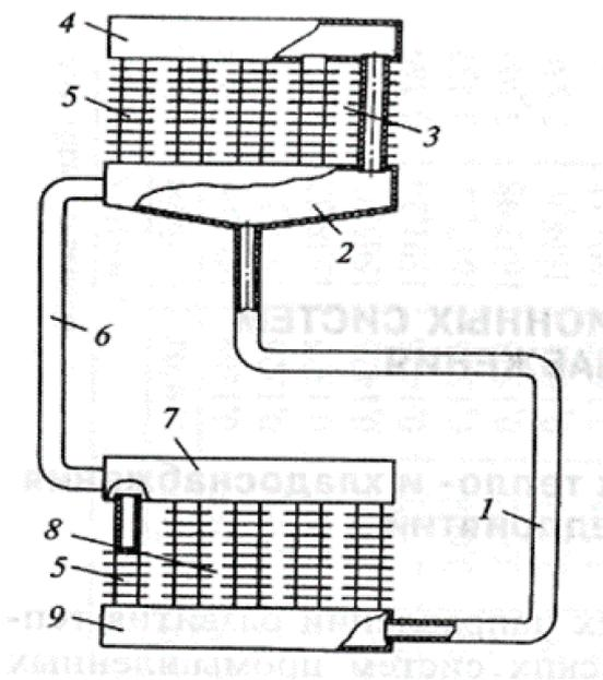
Рис. 3.1. Общий вид теплообменника на термосифонах: 1 – конденсаторопровод; 2 – коллектор; 3 – зона конденсации; 4 – паровая сборная камера; 5 – оребренные трубы; 6 – паропровод; 7 – камера статического давления; 8 – зона испарения; 9 – конденсаторосборная камера
