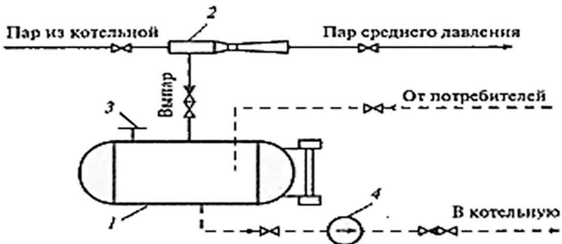
Рис. 2.8. Повышение давления пара вторичного вскипания в пароструйном компрессоре: 1 – бак – расширитель; 2 – струйный компрессор; 3 – предохранительный клапан; 4 – конденсатный насос
