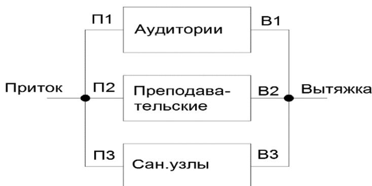
Рисунок 1. Схема приток-помещение-вытяжка
