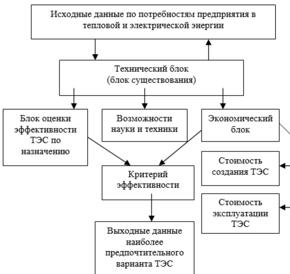
Рисунок 2. Схема математической модели ТЭС
