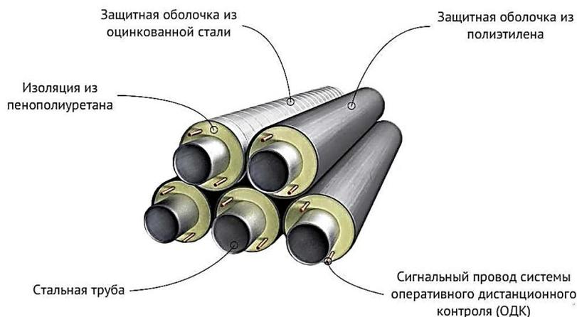
*Рисунок 1. Трубопроводы с пенополиуретановой изоляцией*
