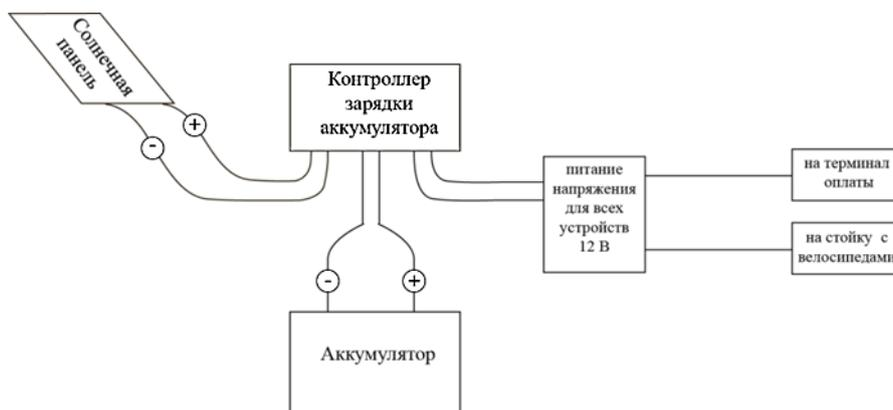
Рисунок 5. Схема передачи энергии
