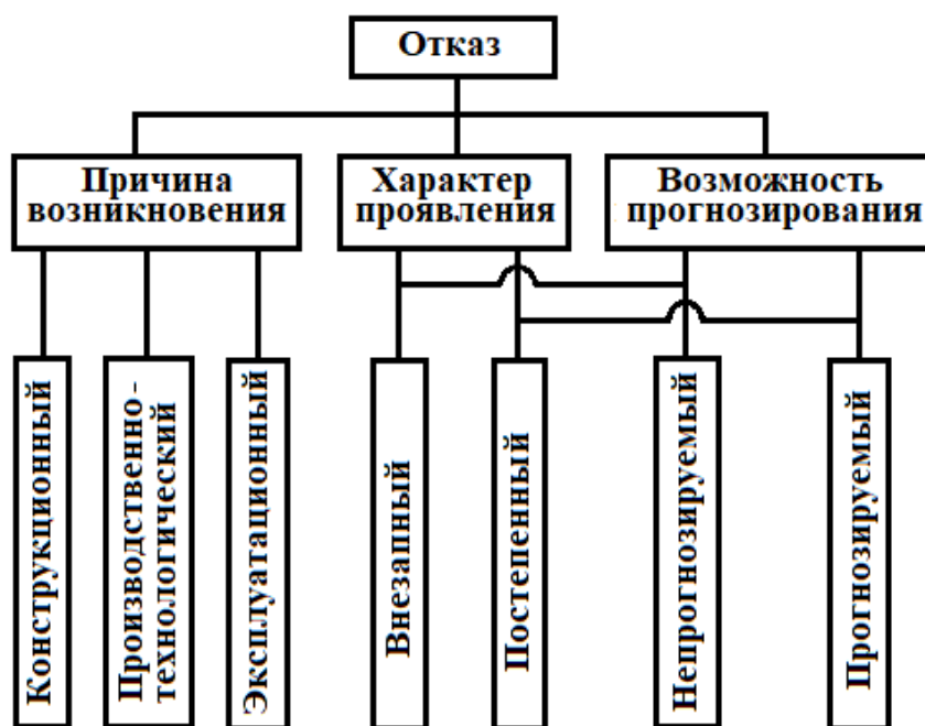
Рис.1.3. Укрупненная схема классификации отказов
