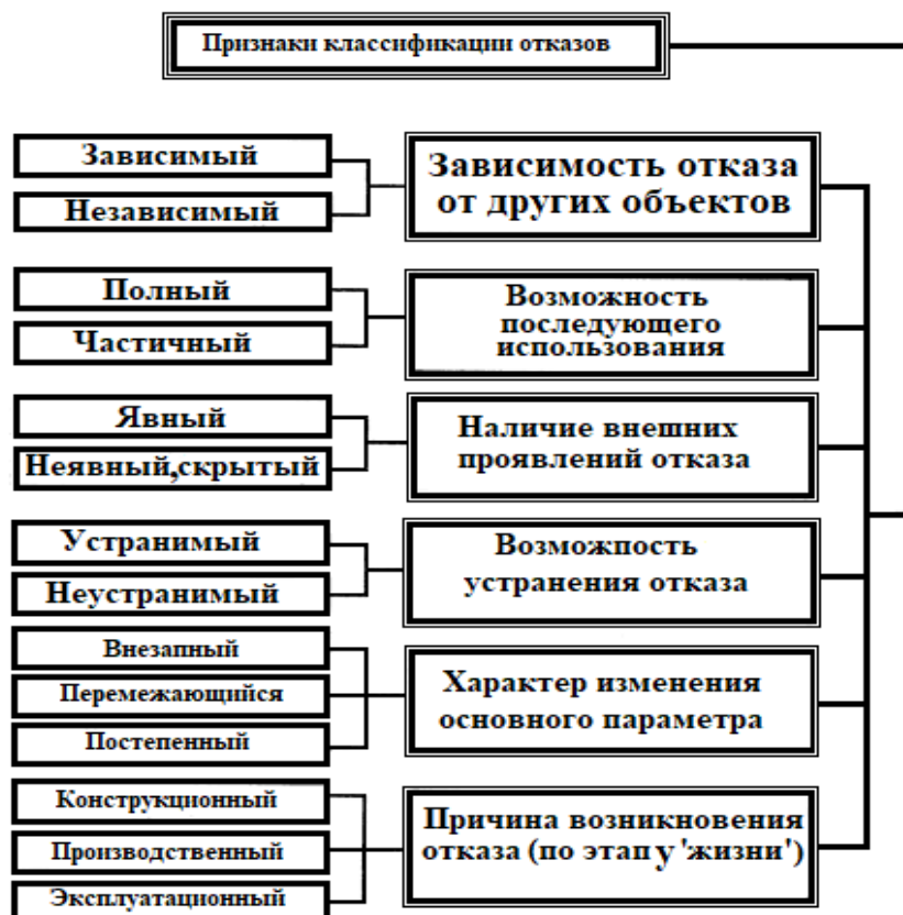
Рис.1.4. Схема классификации отказов по ГОСТ 27.002-89
