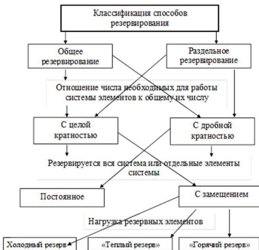
Рис. 7.1 Классификация способов структурного резервирования
