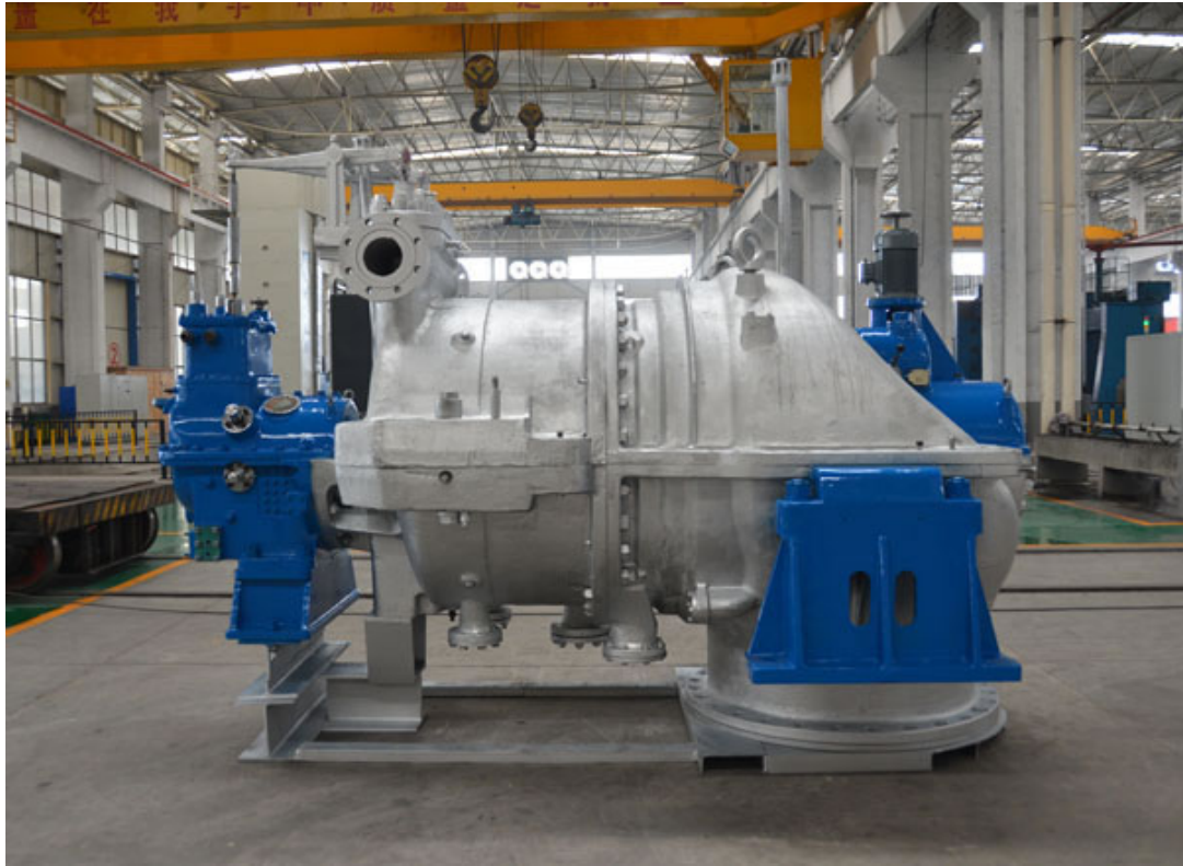
Рис. 3.21. Теплофикационная паровая турбина с противодавлением
