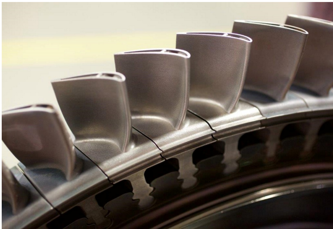
Рис. 3.38. Лопатки ГТУ, выполненные по аддитивной технологии
