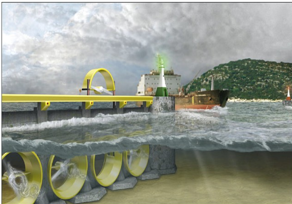
Рис. 1.13. Генераторы приливного потока ПЭС
