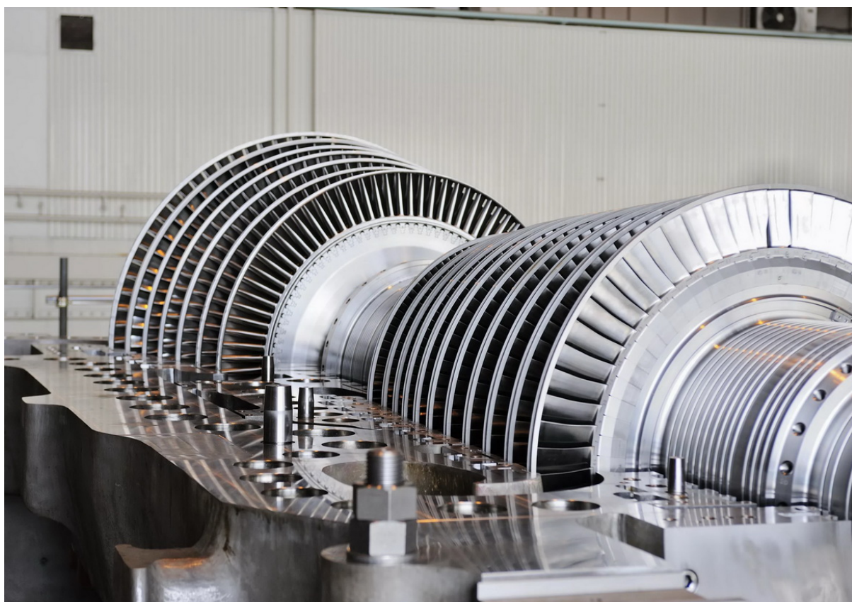
Рис. 3.19. Ротор теплофикационной паровой турбины с отбором пара
