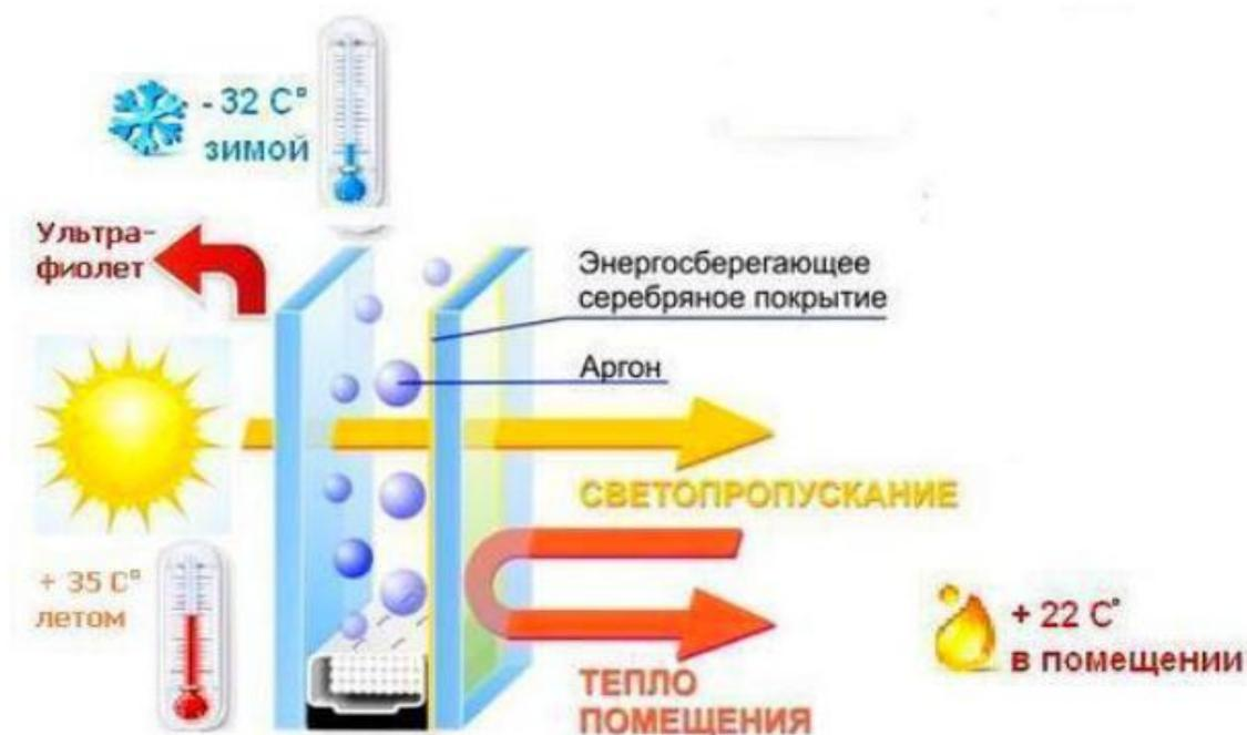
Рис. 10.4. Энергосберегающая камера триплекса окна с И-стеклом
