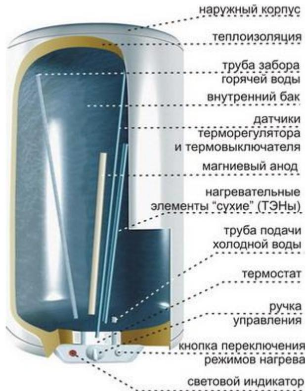
Рис.11.7. Схема устройства емкостного водонагревателя
