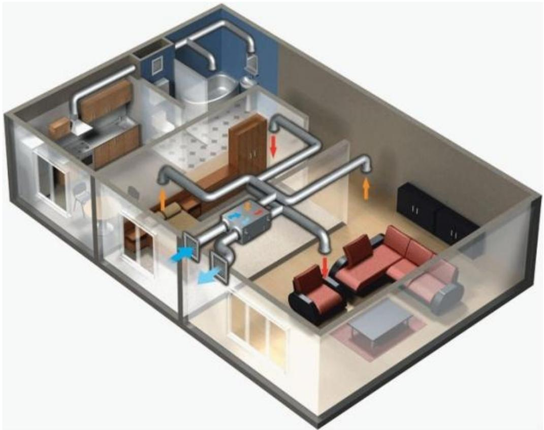
Рис. 10.15 Схема приточно-вытяжной системы вентиляции отдельной квартиры на базе вентиляционной установки с рекуператором
