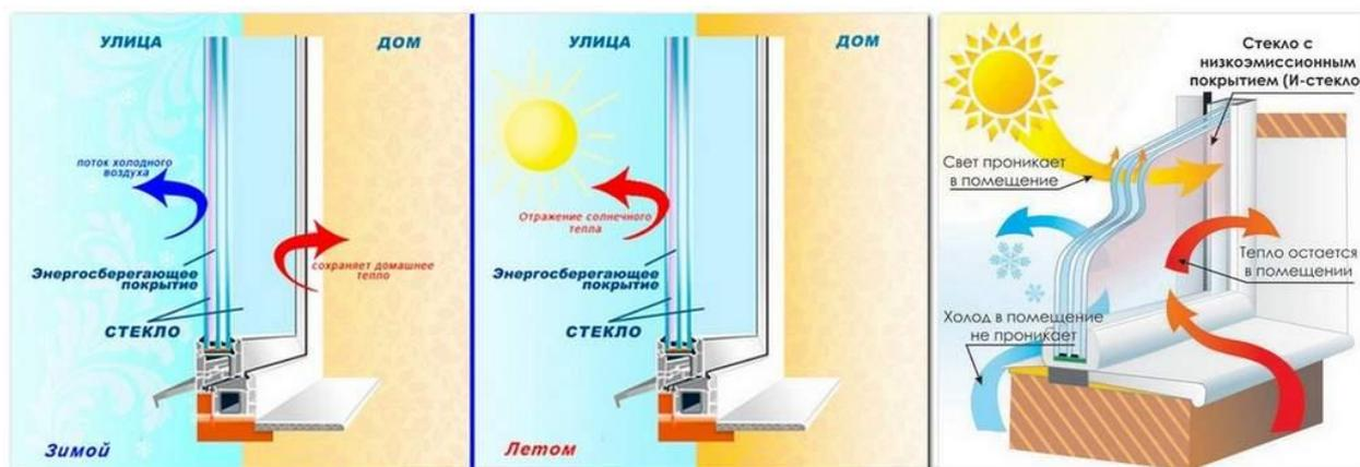
Рис.10.2. Блок оконного стекла с низкоэмиссионным покрытием
