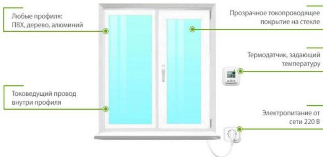
Рис. 10.9. Компоновка системы низкоэмиссионного окна с электрообогревом стёкол
