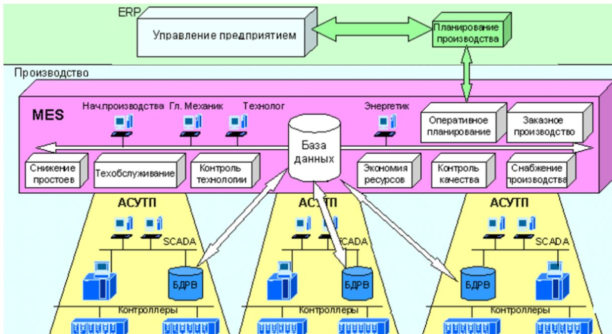
*Рисунок 1. Иерархия систем автоматизации на производстве*
