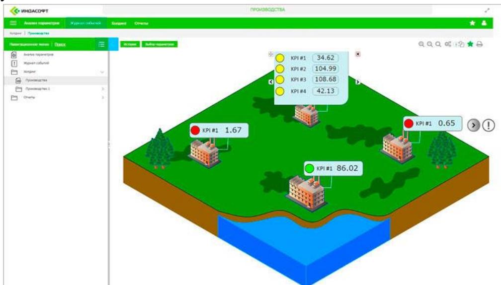
*Рисунок 3. Пример мнемосхемы АСОДУ PI*
