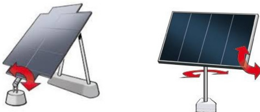
Рисунок 1. Одноосевые и двухосевые системы трекинга (соответственно)
