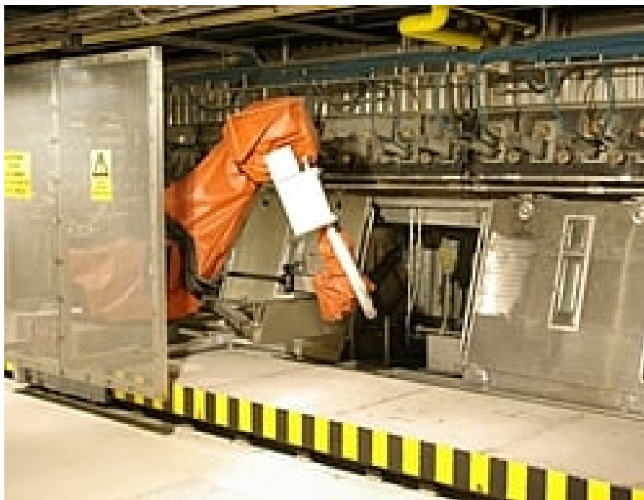
Рисунок 5. Роботизированная рука для автоматической очистки леток плава
