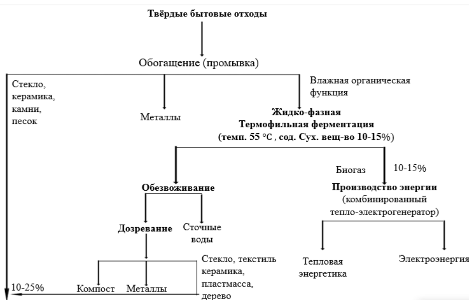
Рисунок 4. Схема переработки ТБО с включением анаэробной ферментации
