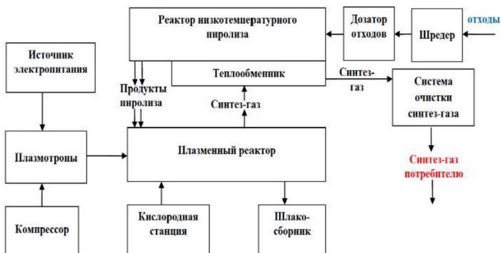
Рисунок 3. Схема для переработки мусорных отходов комбинированным путём
