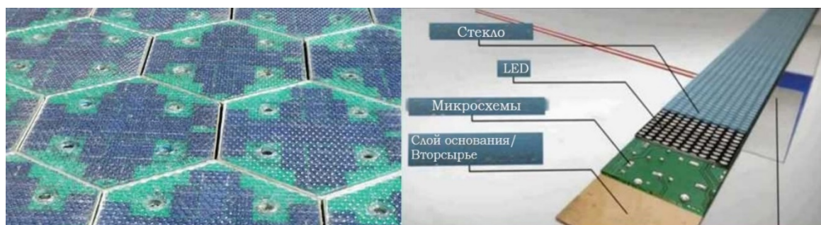
Рисунок 2. Солнечные дорожные панели с нагревательными элементами и светодиодами
