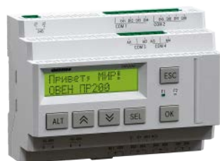
Рисунок 8. ОВЕН ПР200 – программируемое реле с дисплеем
