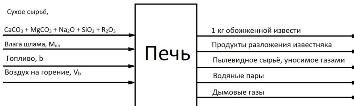
Рис. 1. Схема потоков материала в известерегенерационной печи
