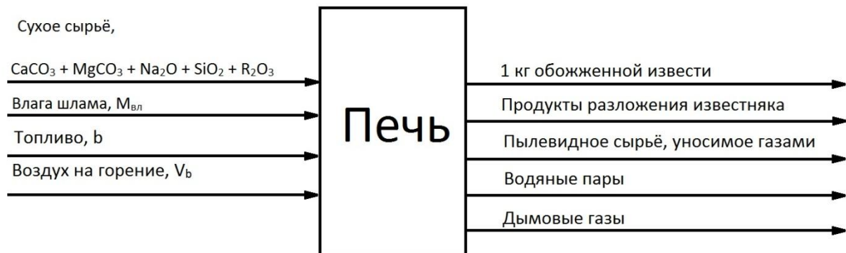
Рис.3. Схема потоков материала в известерегенерационной печи
