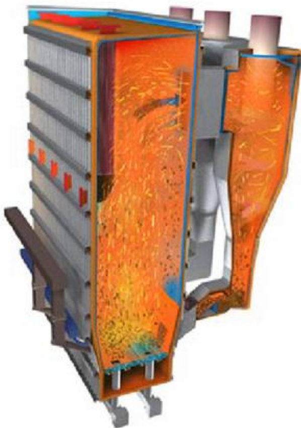
Рис. 24. Топка котла с циркулирующим кипящим слоем
