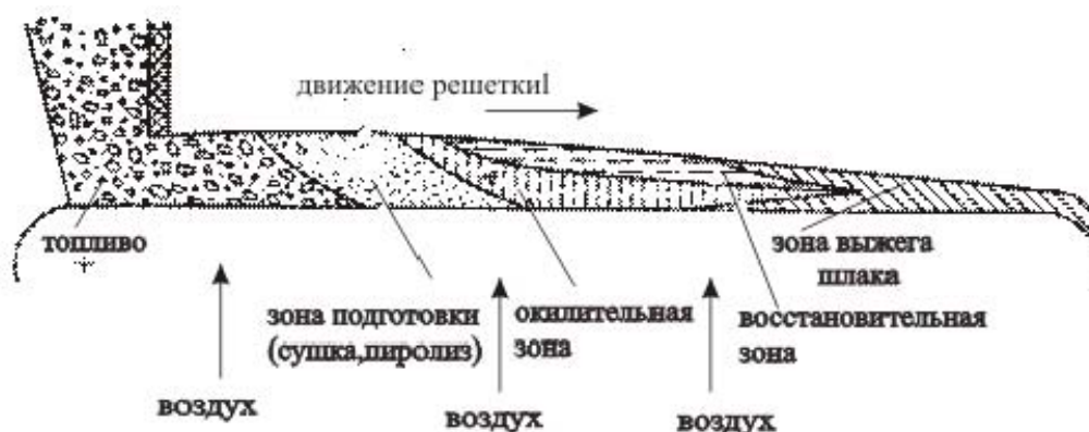
Рис. 20. Схема зажигания слоя на цепной решетке
