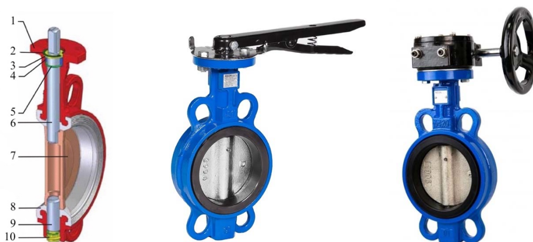
Рисунок 1.4 – Затвор дисковый поворотный: 1 – корпус; 2 – стопорное кольцо; 3 – упорное кольцо; 4 – втулка; 5 – кольцевое уплотнение; 6 – шток; 7 – диск; 8 – седловое уплотнение; 9 – нижний шток; 10 – заглушка
