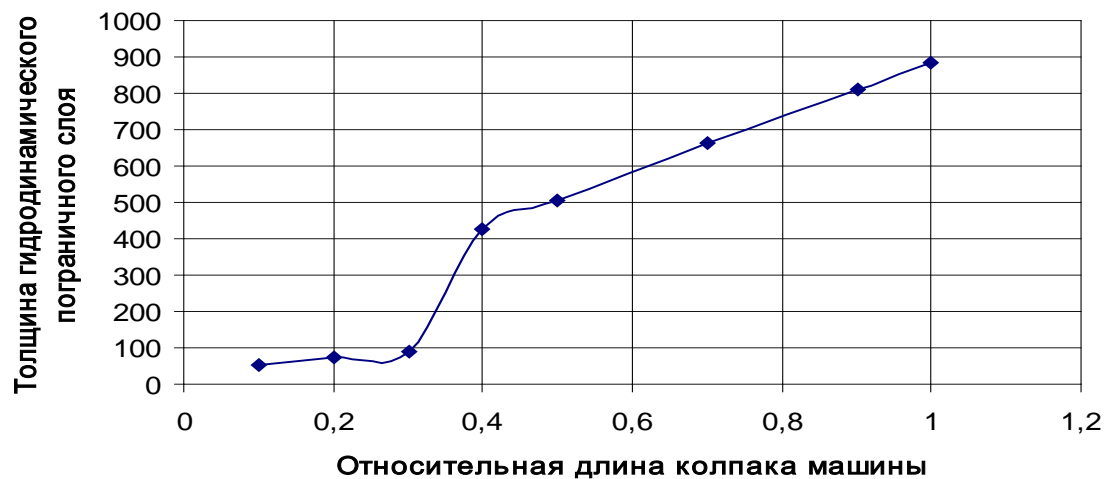
Рисунок 4.12 – Изменение толщины гидродинамического пограничного слоя по длине колпака машины
