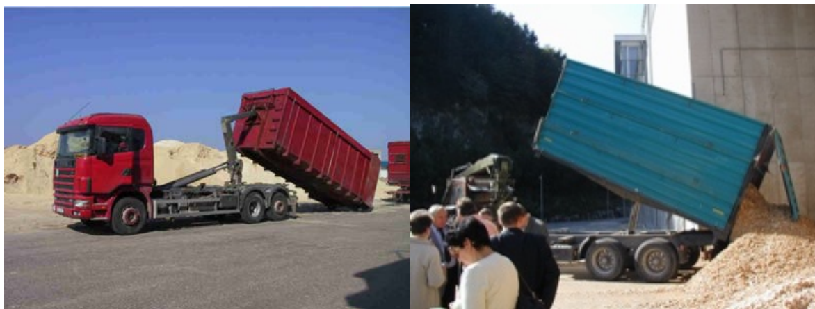
Рисунок 11.2 – Доставка щепы до котельной
