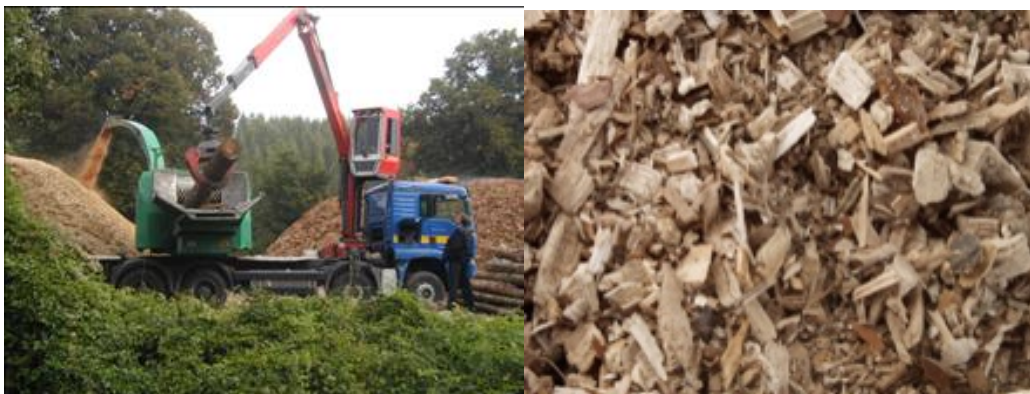
Рисунок 11.1 – Работа рубительной машины
