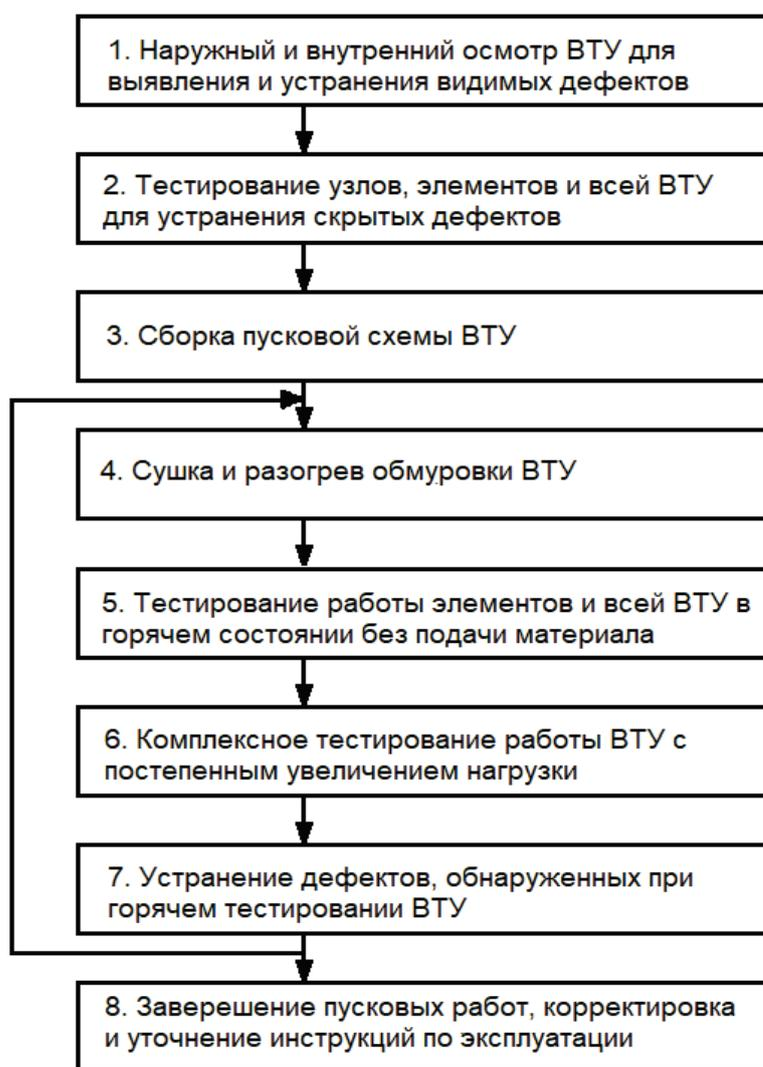
Рисунок 1 – Последовательность пусковых работ на ВТУ
