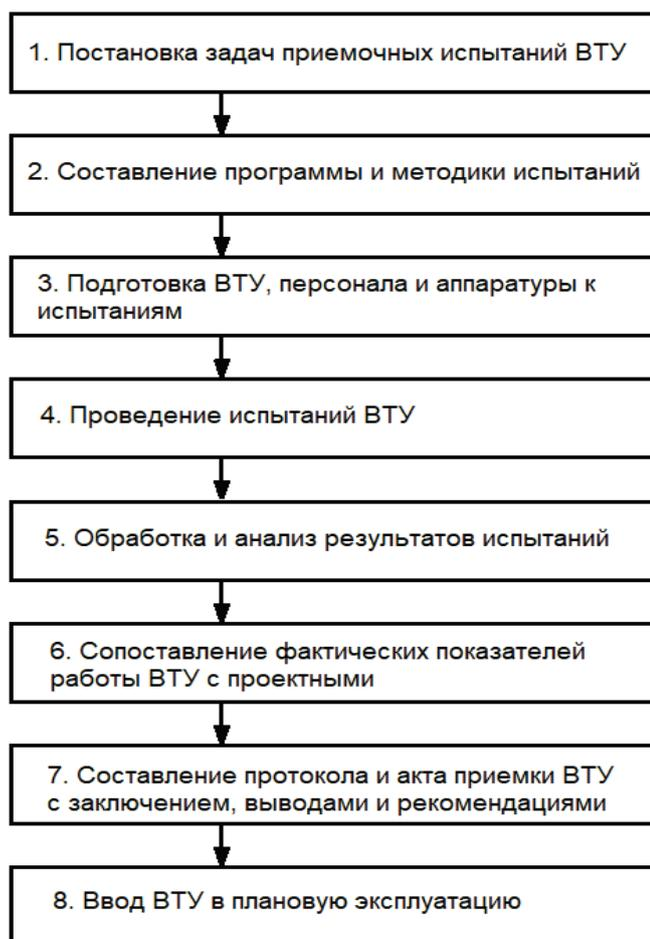
Рисунок 3 – Общая последовательность проведения приемочных испытаний
