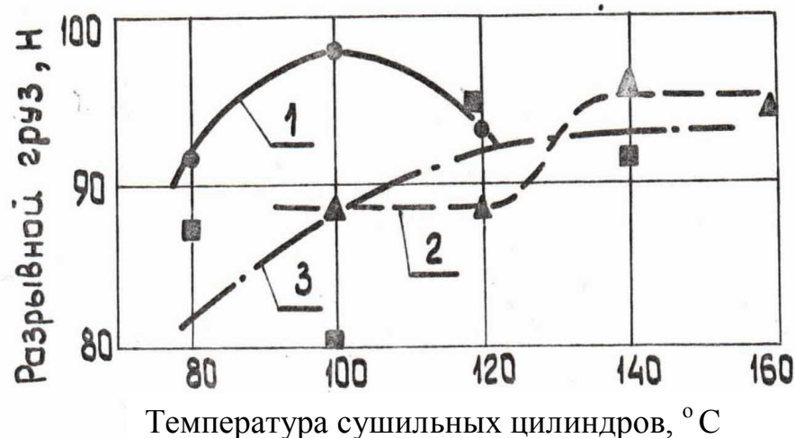
Рис. 3.13. Зависимость разрывного груза бумаги для гофрирования от температуры сушильных цилиндров: 1 – первый период сушки; 2 – первый интервал второго периода сушки; 3 – второй интервал второго периода сушки
