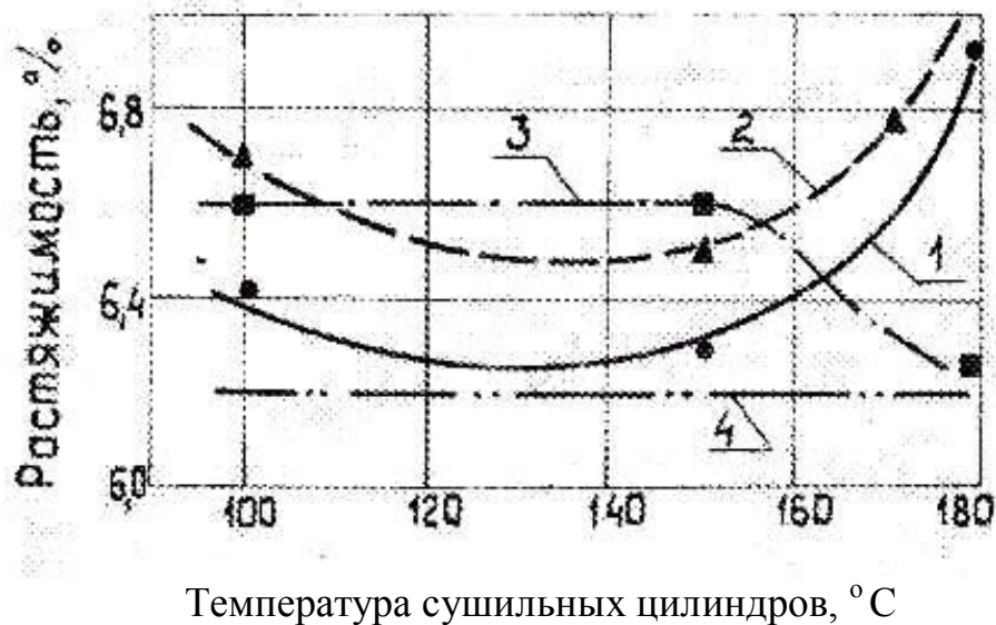
Рис.3.18. Зависимость растяжимости тарного картона от температуры сушильных цилиндров: 1 – первый период сушки; 2 – первый интервал второго периода сушки; 3 – второй интервал второго периода сушки; 4 – сушильный шкаф
