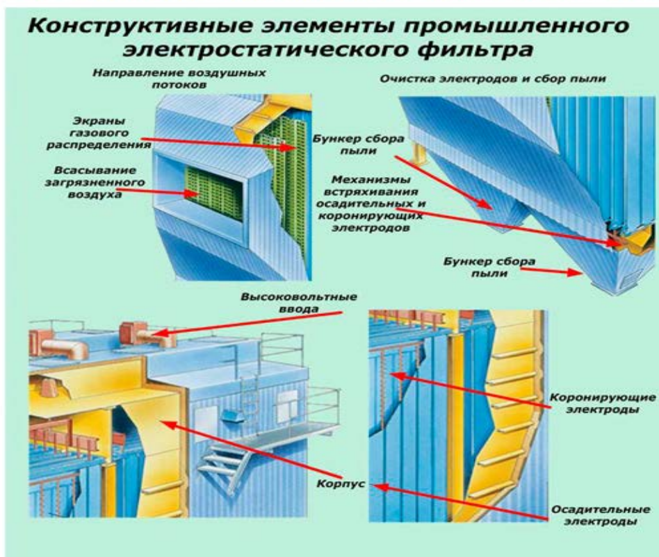
Рис. 6. Конструкция промышленного электрофильтра
