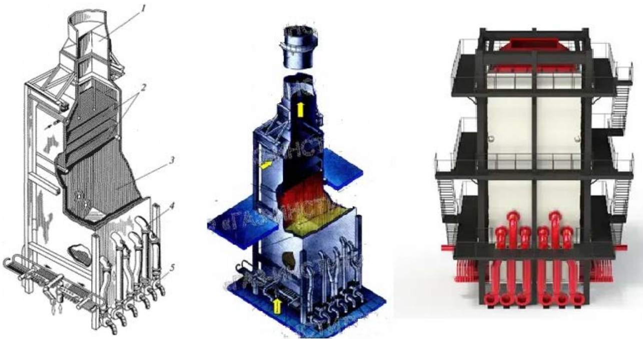
Рис. 4.10. Водогрейные котлы ПТВМ-50:
