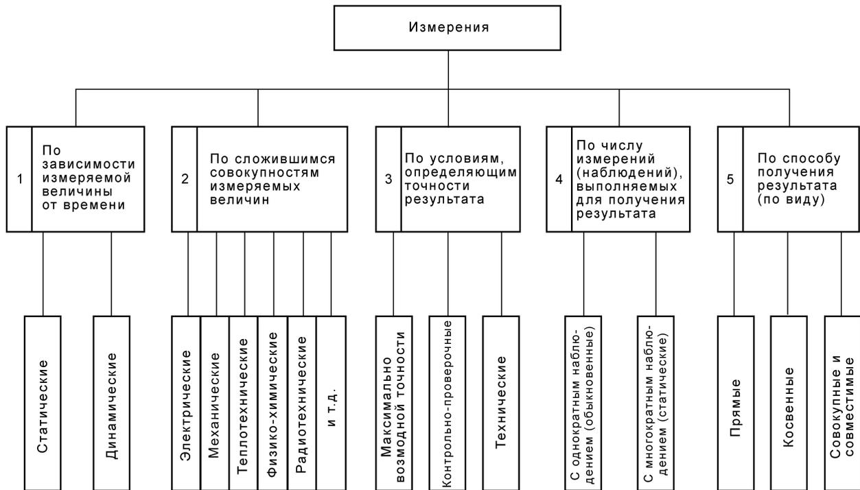
Рис. 2.1. Классификация измерений
