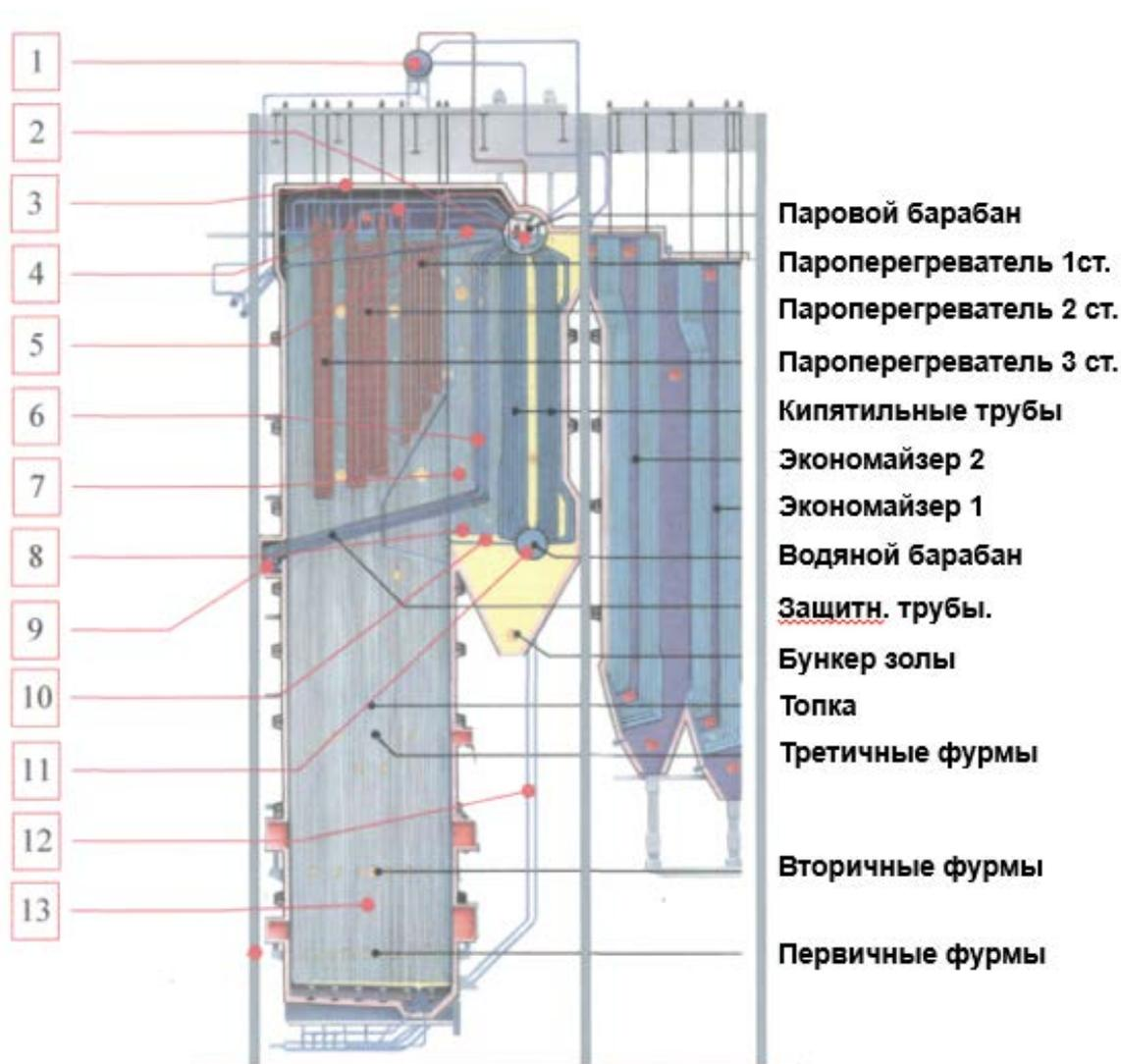
Рис. 39. Содорегенерационный котлоагрегат:
