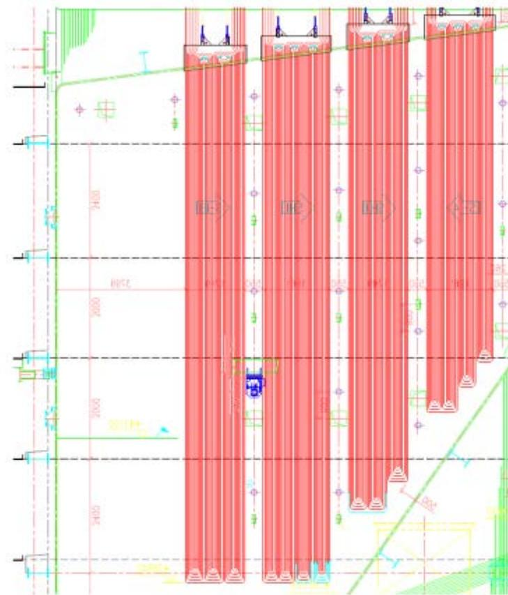
Рис. 43. Ширмовый пароперегреватель
