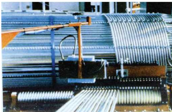
Рис. 4.18. Изготовление бухтового змеевика для ПГ АЭС «Суперфеникс»
