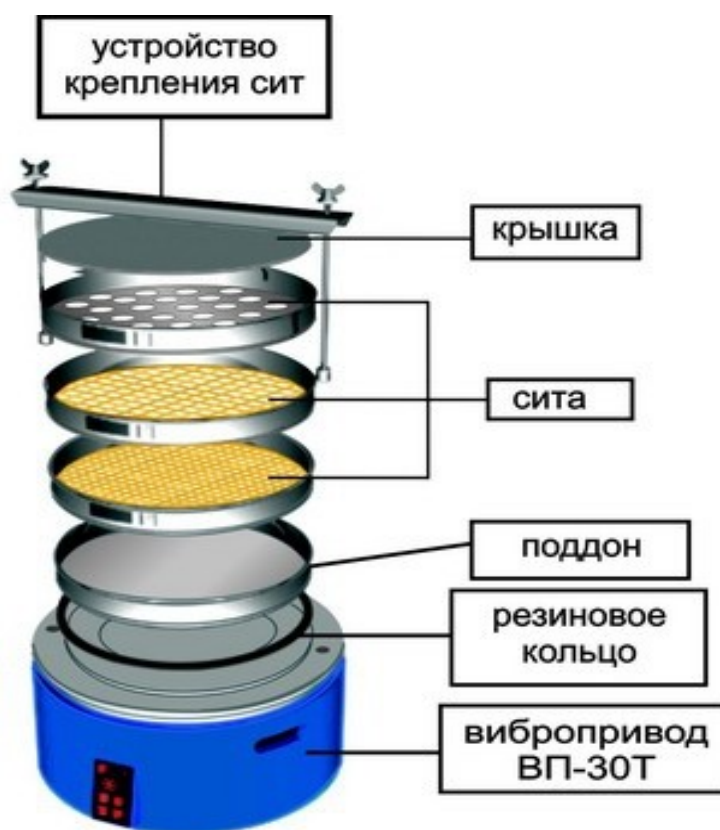
Рис. 11.1. Установка для ситового анализа твёрдого топлива
