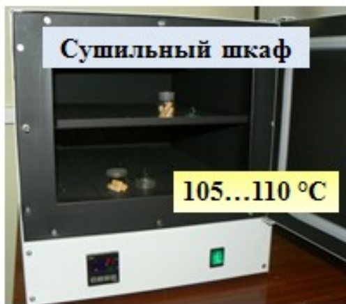
Рис. 6.3. Определение влажности твёрдого топлива
