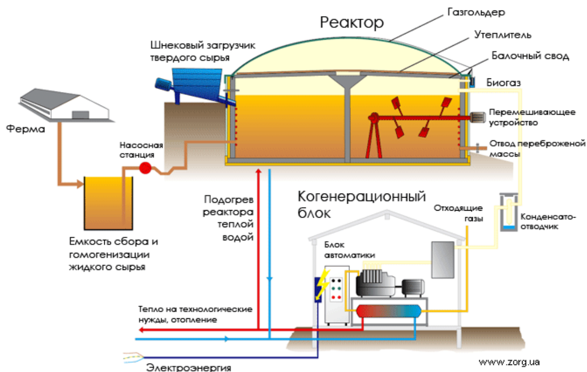
Рис. 14.2. Схема промышленной установки по производству биогаза
