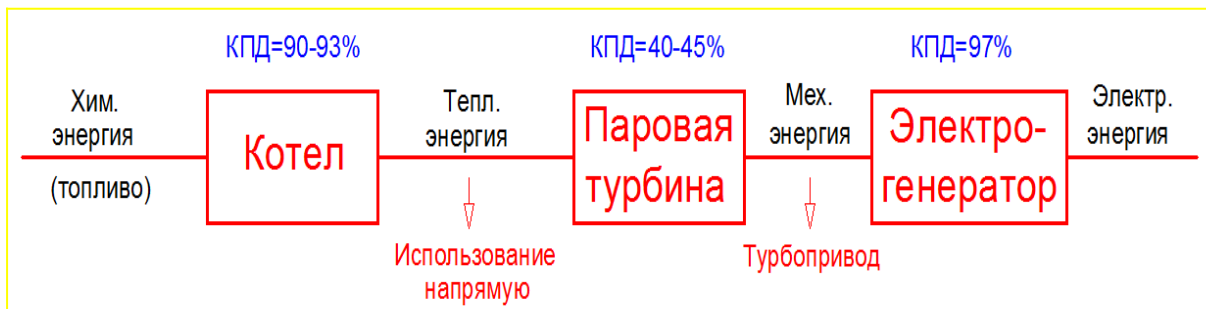
Рис. 2.1. Схема превращения энергии на современной ТЭС
