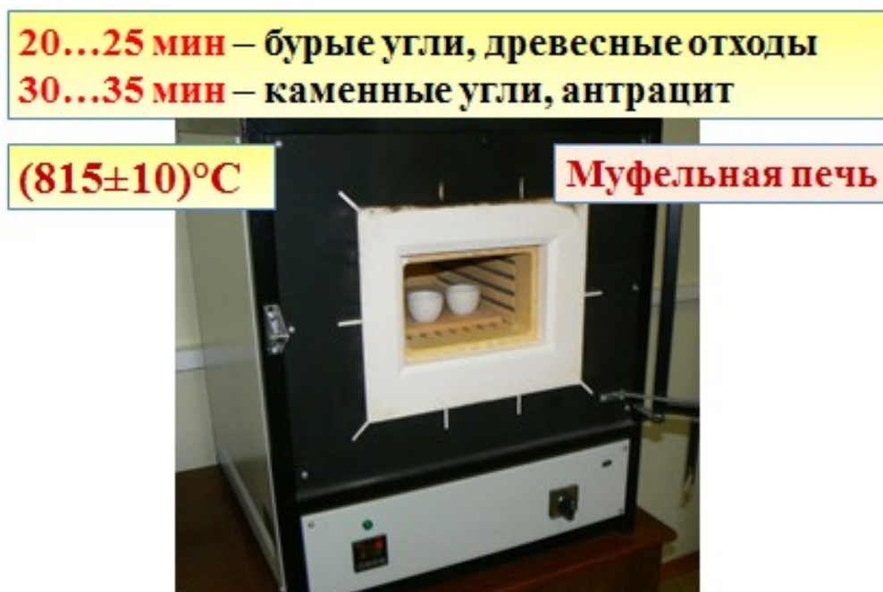
Рис. 6.5. Определение зольности топлива
