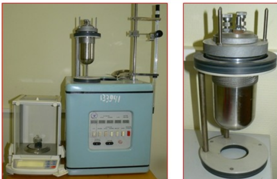
Рис. 6.8. Калориметрическая установка и бомба Крекера
