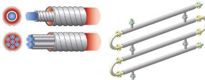
Рис. 5. Теплообменник труба в трубе
