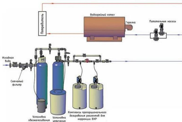
Рис. 6. Подготовка воды в блок-модульных котельных
